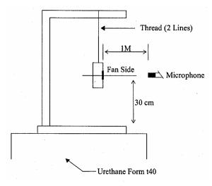
1 METER FROM MICROPHONE TO FAN INTAKE
