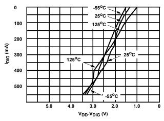
FIGURE 5. COMMON ANODE DIGIT DRIVER  $I_{\mbox{\scriptsize DIG}}$  vs  $(V_{\mbox{\scriptsize DD}}$  -  $V_{\mbox{\scriptsize DIG}})$
