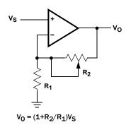
FIGURE 14. NONINVERTING AMPLIFIER
