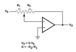
FIGURE 20. INVERTING AMPLIFIER
