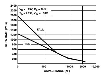
FIGURE 12. SLEW RATE vs LOAD CAPACITANCE
