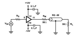
FIGURE 6. VIDEO COAXIAL LINE DRIVER  $50\Omega$  SYSTEM
