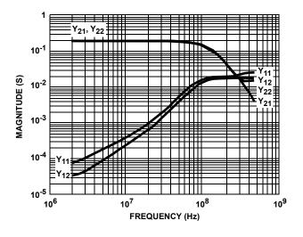
FIGURE 19. Y - PARAMETER MAGNITUDE vs FREQUENCY
