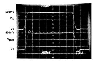
$T_{\mbox{\scriptsize A}}=25^{\circ}\mbox{\scriptsize C},\, R_{\mbox{\scriptsize S}}=50\Omega,\, R_{\mbox{\scriptsize L}}=100\Omega$
