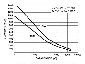
FIGURE 13. SLEW RATE vs LOAD CAPACITANCE
