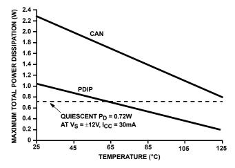
FIGURE 5. MAXIMUM POWER DISSIPATION vs TEMPERATURE
